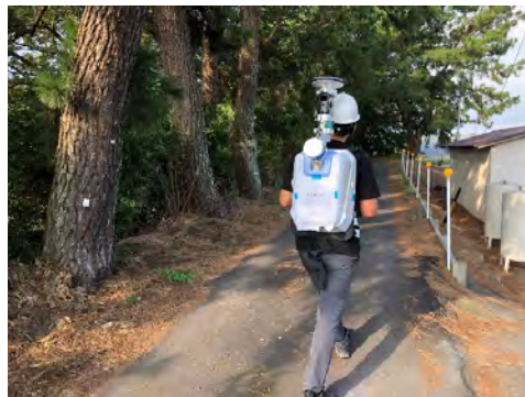
(レーザー測量計測の様子)
